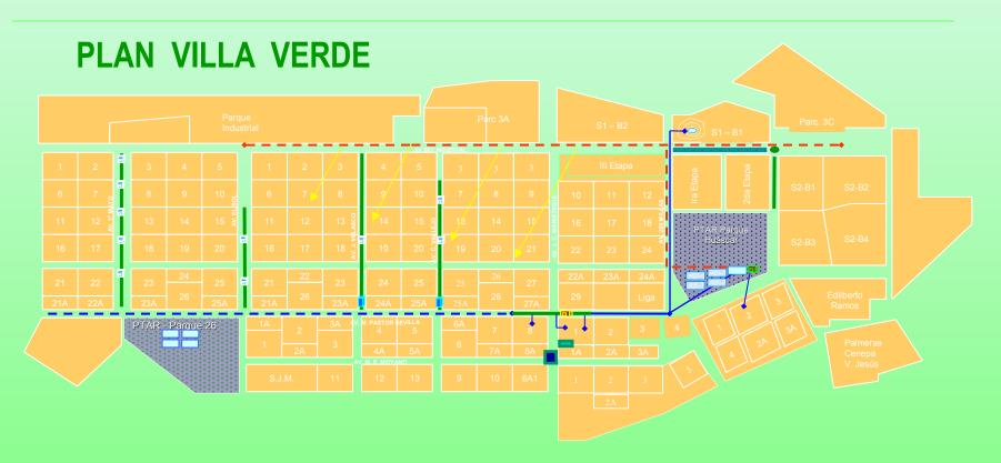
Captación de la PTAR Huascar, bombeo hacia la cota más alta Av. Sep. Industrial x gravedad e impulsión hidromecánica hacia las cotas bajas.
